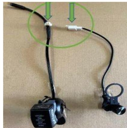
**Para los modelos anteriores a agosto de 2020** la operación sigue siendo la misma, simplemente el cableado cambia para esto será necesario conectar el conector del sensor en serie al conector del gatillo (flechas amarillas en la foto).
