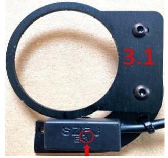
**Advertencia:** El área donde el sensor detecta movimiento está a la altura de la "F" del script "SZFJ" (foto 3.1) esta carta debe colocarse lo más cerca posible del eje, cualquier inversión de posición de uno de los elementos causará un mal funcionamiento.
